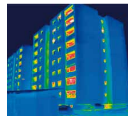
Warmteverlies na renovatie
